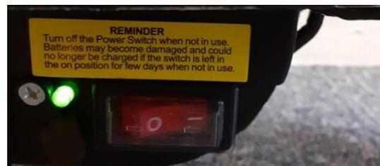
Si la LED de la trottinette ne s'allume pas, **éteindre** la trottinette puis **appuyer** sur le bouton de réinitialisation du disjoncteur afin de le réenclencher.
