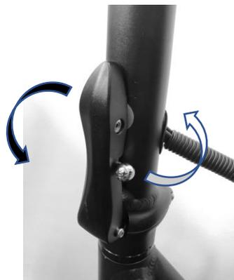
Lever le verrou métallique vers le haut et tirer le loquet de verrouillage (7) vers le bas. Plier la potence
