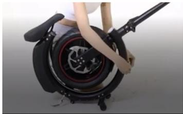
5/ Assembler les 2 roues par le système d'aimant, et serrer le verrou de pliage/dépliage A (10)
