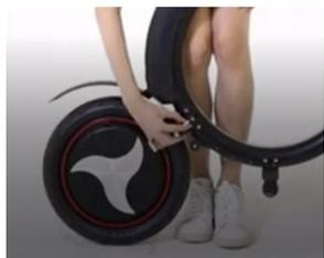
1/ Desserrer le verrou de pliage/dépliage B (11) de la roue arrière
