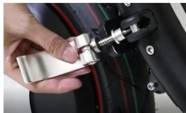
10/ Pour ajuster le verrou de pliage/dépliage, tirer vers le bas sur la goupille
