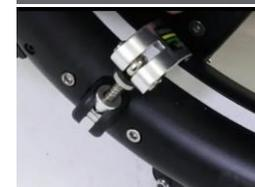
8/ Sur le verrou de pliage/dépliage B (11), tirer la goupille vers le bas pour lever le verrou
