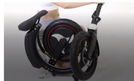
4/ Desserrer le verrou de pliage/dépliage A (10) et effectuer une rotation de la roue avant vers l'intérieur
