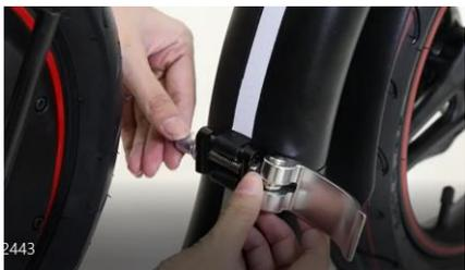
5/ Visser et serrer le verrou pliage/dépliage A (10) de la roue avant.
