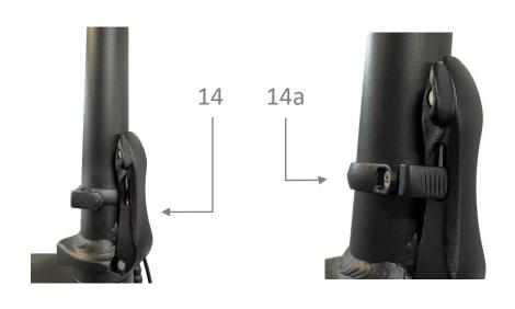
2. Pousser le loquet de verrouillage (14) à fond contre la potence (15). Vérifier que le verrou est bien enclenché. Faire tourner la bague (14a) et insérer la sécurité dans le loquet (14).
