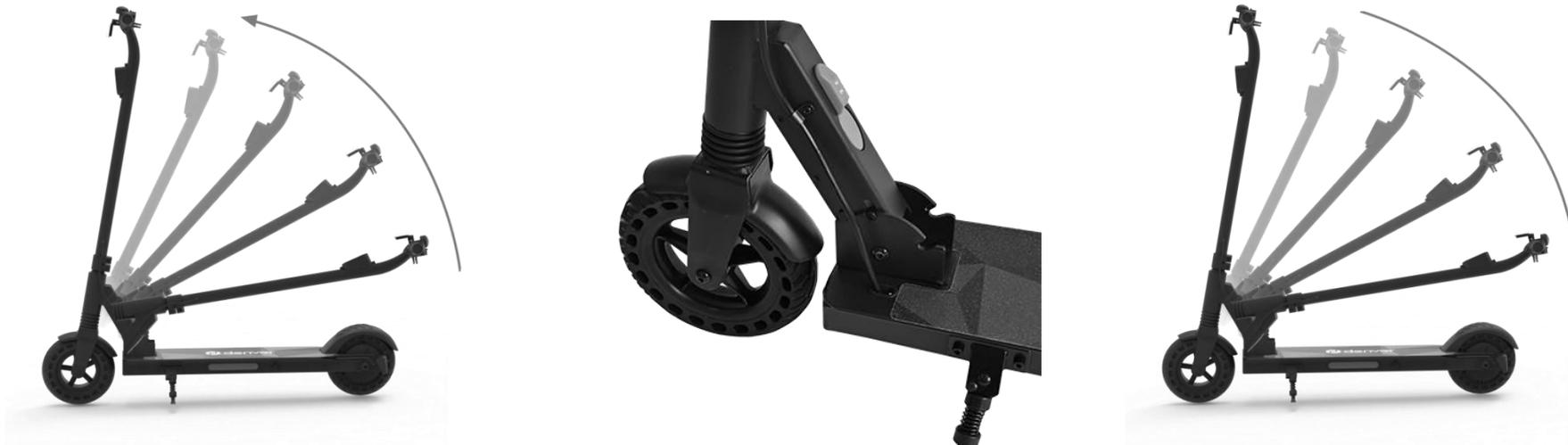
Appuyer sur le loquet de pliage (17) tout en soulevant le loquet de sécurité jusqu'à ce que la goupille de positionnement atteigne l'emplacement comme sur l'image ci-dessus. Répéter cette manipulation afin de plier la trottinette.
