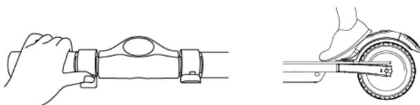
Actionner le frein électrique (13) pour ralentir ou appuyer doucement sur le frein au pied (8)
