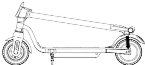
Appuyer sur le garde-boue (8) et dégager le crochet de verrouillage (4)
