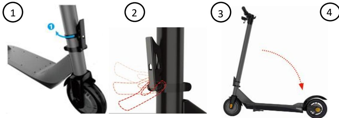
1 Glisser la bague se trouvant au centre du loquet de pliage (9) vers l'extérieur.
