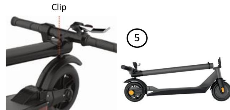
4 Verrouiller le crochet (20) dans le verrou de pliage (21) situé sur le garde-boue arrière (15).
